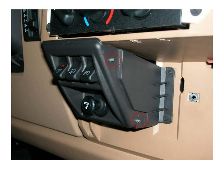
Affiancare il supporto nuovo inserendolo nei perni e verificando la corretta battuta applicare una squadretta di metallo per il fissaggio alla plancia del lato destro del supporto stesso.
