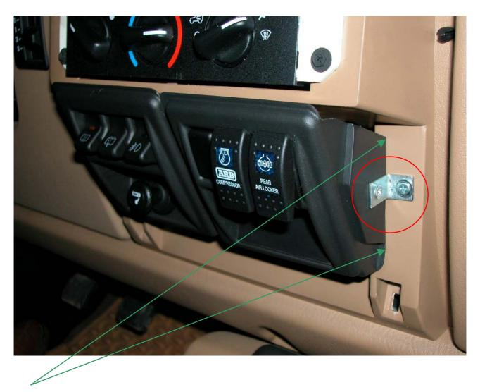
Dettaglio: il taglio in diagonale del punto 5 va eseguito a regola d'arte in modo da adattare il pezzo alla battuta della scocca.
