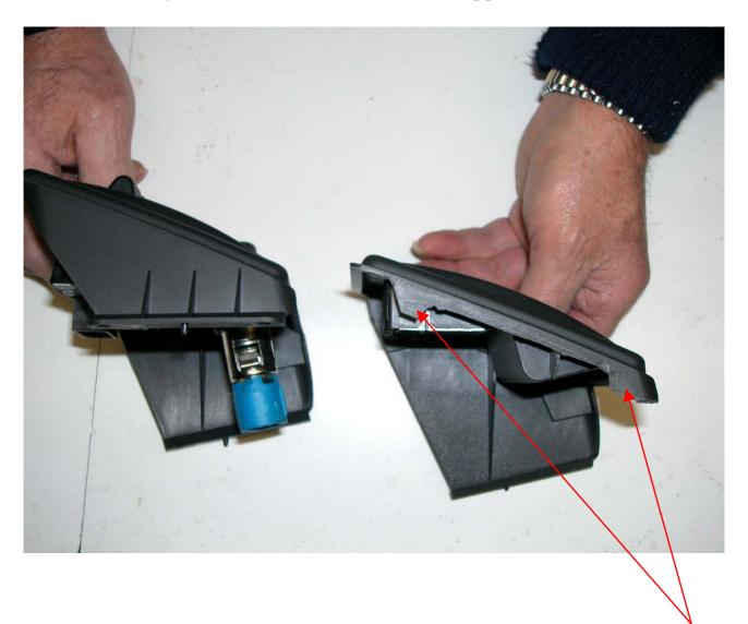
Questo serve per poter accostare in maniera idonea i due pezzi. Prestate molta attenzione nel lasciare le due zone indicate che serviranno in seguito per accoppiare i due supporti.
